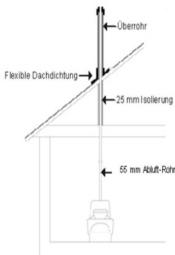
**Abb. 1 Installationspaket** besteht aus: Insektennetz, Reduzierstück, 1 m Rohr 110 mm, 25 mm Isolierung, Dachabdichtung, 25 mm Isolierung, 4 x 1 m Abluft-Rohr 55 mm
